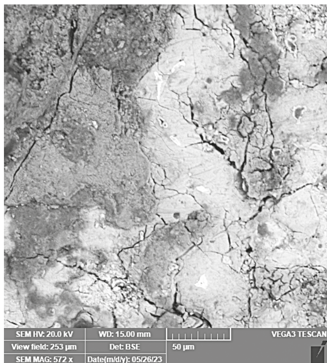
Obr. 9. Sekerka inv. č. A 31662/1. Světlá místa: zkorodovaná intermetalická eutektoická fáze \alpha + \delta . Foto Š. Msallamová.
