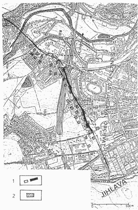
Obr. 1. Jihlava: Důlní činnost z 13. až 18. stol. v prostoru projektovaného obchvatu silnice I/38. 1 – Starohorská dislokační zóna. Prozkoumaný úsek sledovaný historickými hornickými pracemi (dle Pluskal -Vosáhlo 1998), 2 – Situace pinkových a odvalových řad. The 13 th - 18 th Century mining activities in the area of the projected road I/38.
