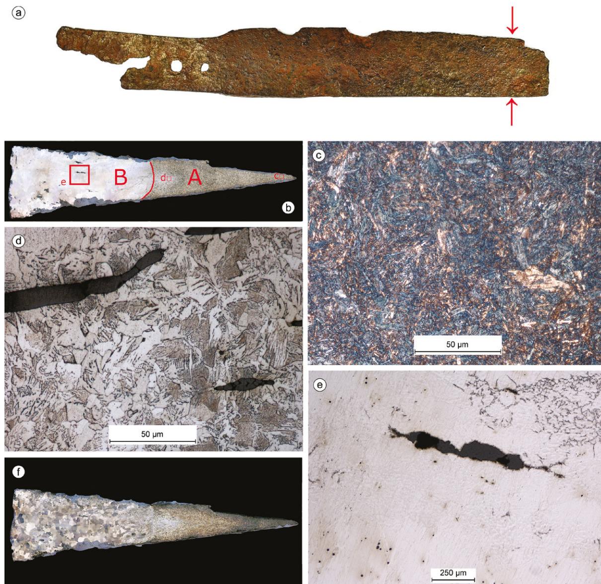
Obr. 27. Metalografický rozbor čepele torza tesáku: a – místo odběru vzorku; b – celková situace ve vzorku s vyznačenými strukturálními částmi (A – ocelové ostří, B – železné tělo), svarem mezi nimi, a místy podrobného rozboru – viz obr. c, d, e (leptáno nitalem); c – typická situace v strukturální části A poblíž hrotu: martenzitická struktura (leptáno nitalem); d – situace v strukturální části A poblíž svaru s částí B: perliticko-feritická struktura (leptáno nitalem); e – typická situace v strukturální části B: ferit s nezřetelnými hranicemi zrn a „ghost structure“ v centru záběru (pod velkým černým struskovým vměstkem), vpravo nahoře ferit s ostrůvky perlitu (leptáno nitalem); f – celková situace ve vzorku (leptáno Oberhofferovým činidlem) (foto P. Bárta).
